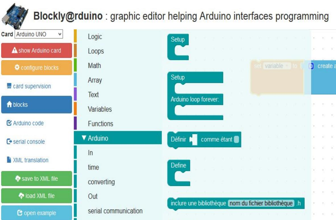
Blockly@rduino est basé sur [Blockly](#), un éditeur de programme graphique par une interface web. Il fournit un seul type de traduction de la programmation graphique (*contrairement à Blockly qui traduit en Python, en JavaScript, etc et permet de le simuler en ligne : [exemple](#)*), pour générer du code à copier coller dans l'IDE Arduino.
