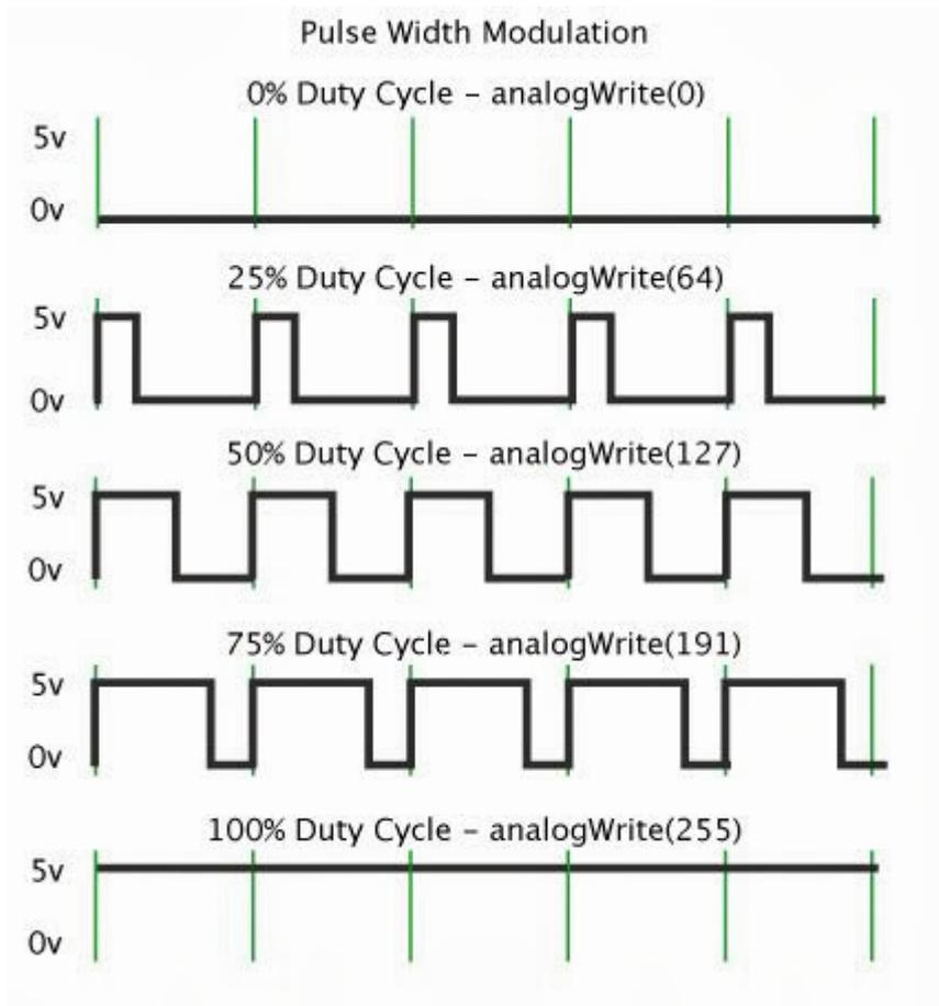
La carte Arduino Uno comporte 6 pins marquées d'un signe (3, 5, 6, 9, 10 et 11) qui permettent chacune une sortie en mode PWM. **3 sont utilisées ici : une par teinte.**
