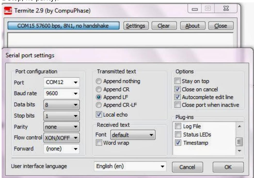
Le logiciel sur le PC reçoit les données du module bluetooth et les affiche en vert (avec horodatage si on l'a activé).
