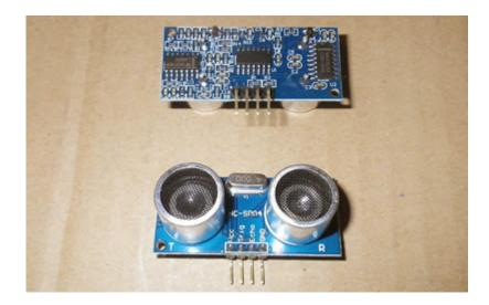
La vitesse du son est de 340 m/s (il faut 29,4 microsecondes pour parcourir 1 cm). En 1 ms, l'onde ultrasonore se déplace de 340 mm = 34 cm. Le capteur fournit une  $\,$ .
