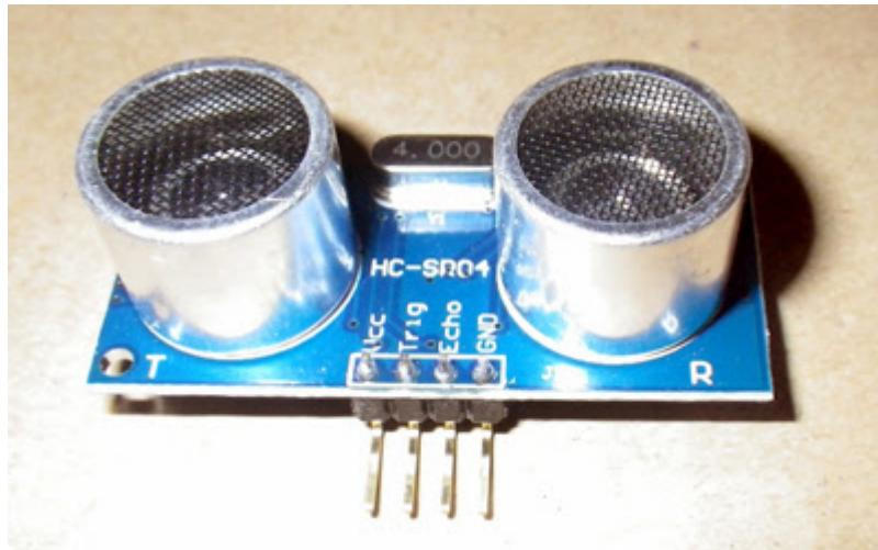
Le module à ultra-sons permet de détecter automatiquement un obstacle dans un **angle de visée étroit de 15°**, et de mesurer une distance sans contacts, sur une portée de 2 cm à 450 cm.
