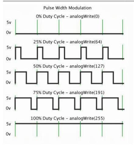
La carte Arduino Uno comporte 6 pins marquées d'un signe (3, 5, 6, 9, 10 et 11) qui permettent chacune une sortie en mode PWM. **3 sont utilisées ici : une par teinte**.
