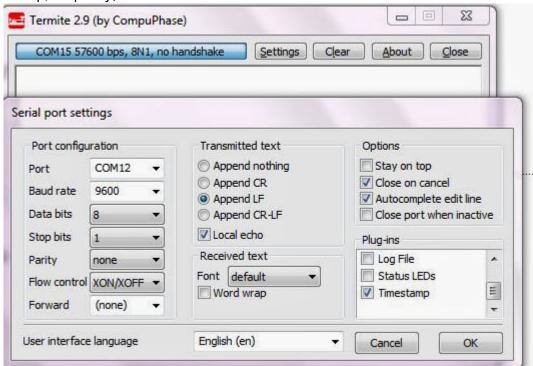
Le logiciel sur le PC reçoit les données du module bluetooth et les affiche en vert (avec horodatage si on l'a activé).
